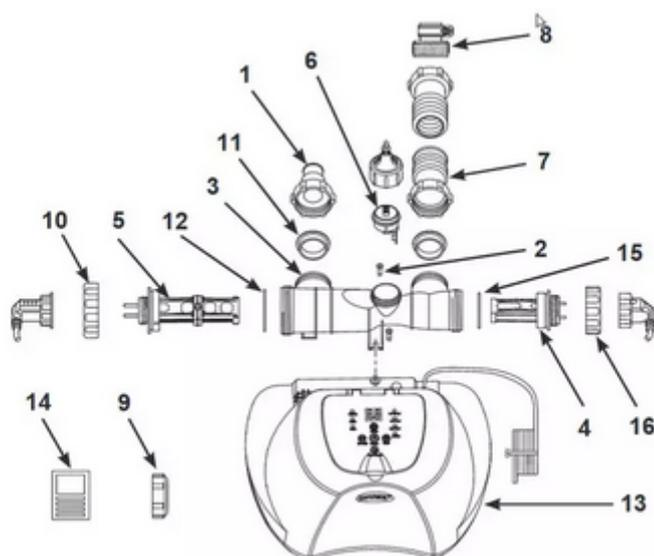
Titan Elektrode: längere, primäre Zelle - Position 5
